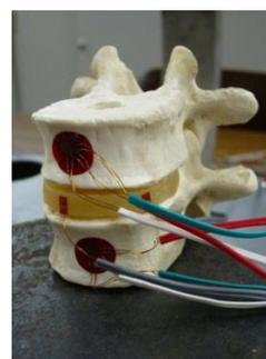
写真 4 ひずみゲージ貼付の状況
